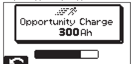
Indikering vid start av mellanladdning
