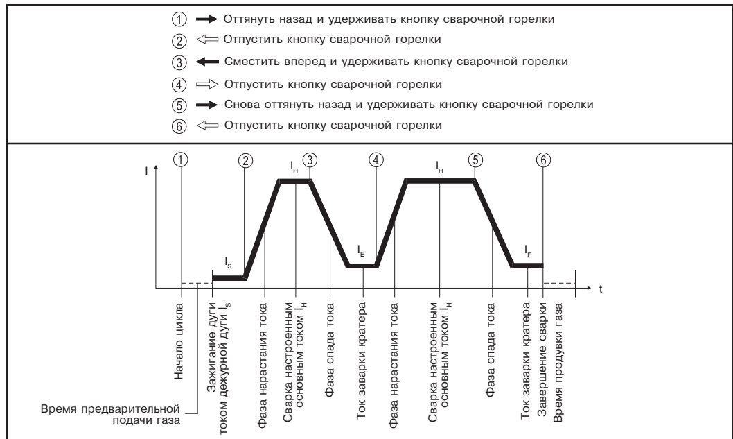
Рис. 12. Ход процесса: 4-тактный режим сварки, вариант I (с временным снижением силы тока)
