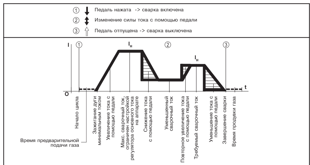
Рис. 27. Ход процесса: сварка с помощью педали дистанционного управления TR 52mc
